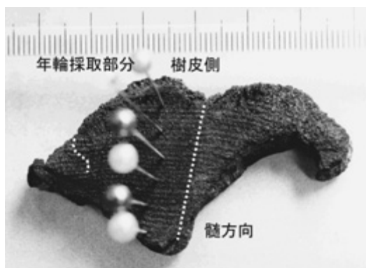
図3. 第27次木柱分取試料 (乾燥後) (白線は年輪採取の境界)
