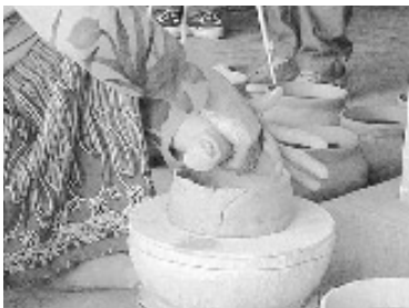
写真11 雲南省タイ族自治区曼斗村(中国) 太めの粘土紐を内傾でねじ立てる事例
