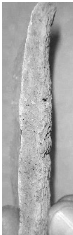
写真3 断面拡大 破断面での外傾の粒子配向
