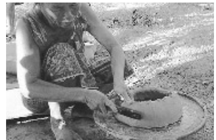
写真13 サラワン県ディンコック村(ラオス) 粘土板を圧着せずに外傾に置く事例
