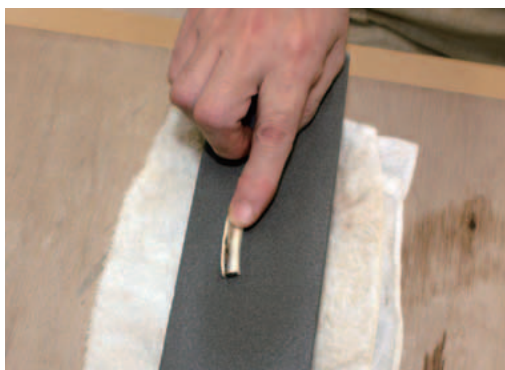
② 側面を砥石で研磨する。緻密質を削り取り、海綿質を露出させる。
