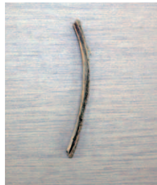
② 側面を砥石で研磨する。緻密質を削り取り、海綿質を露出させる。
